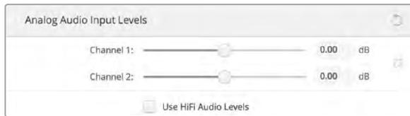
Ajustez les curseurs du canal d'entrée pour contrôler les niveaux d'entrée audio analogique. Cochez la case Use HiFi Audio Levels si vous connectez du matériel audio grand public.
