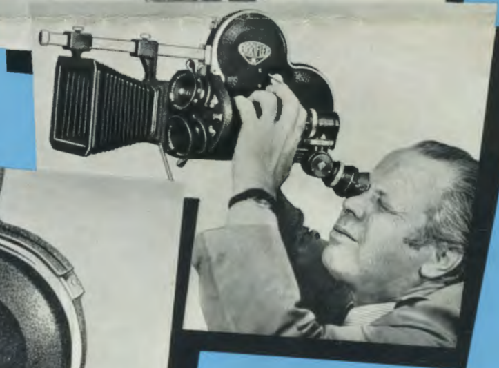
Betrachtungsstellung für Aufnahmen über Hindernisse (Periskop-Stellung)
