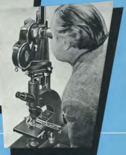
Winkelstück in 90° Stellung zum Einblick seitlich zur Kamera für Trick-, Mikro-, Makro-, Schirmbildaufnahmen, usw.
